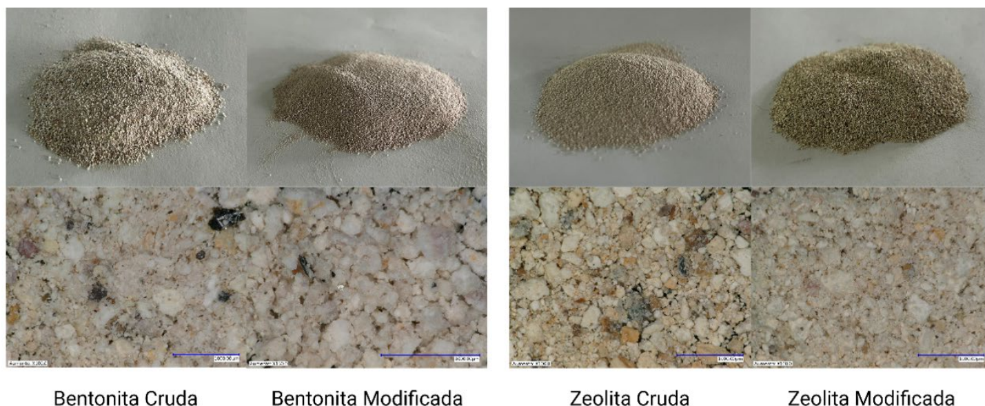
Figura 4. Bentonita y zeolita nativas del estado de Durango: (A) Naturales o crudas. (B) Imágenes tomadas por los autores.
