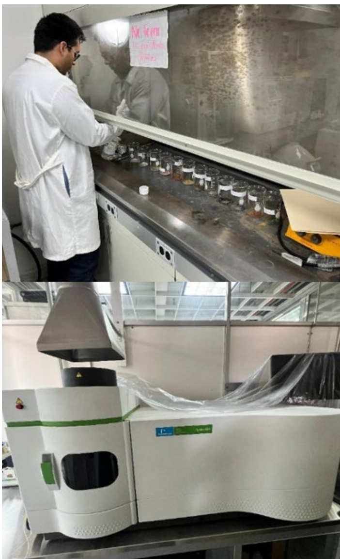
Figura 2. Análisis de muestras de suelo mediante digestión ácida, utilizando espectrometría óptica acoplada inductivamente. (Fotografía tomada por Herrera-Figueroa).
