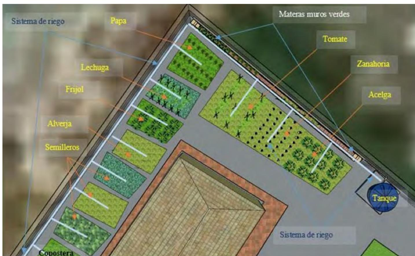
Figura 2. Sistema de riego por goteo vista en planta
