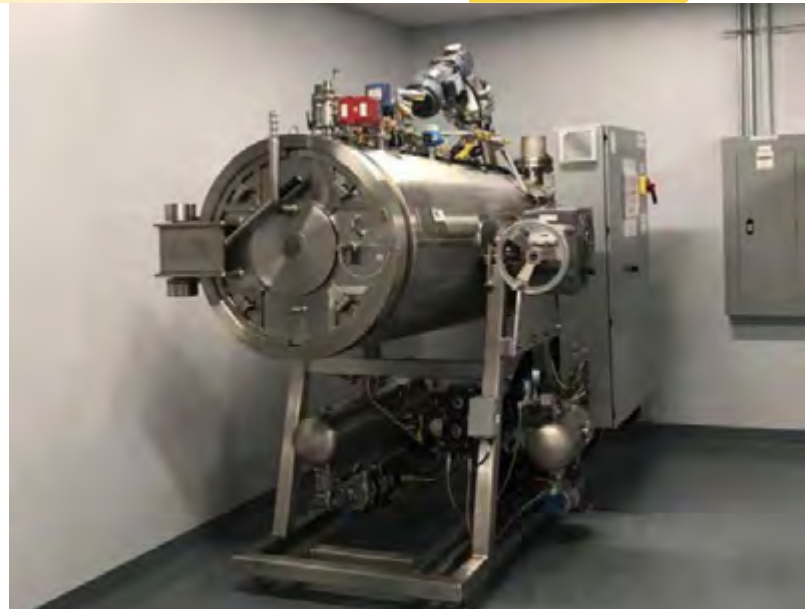
Figura 1. Cámara de presión para la aquamación (Bio Response Solutions, s.f.)
