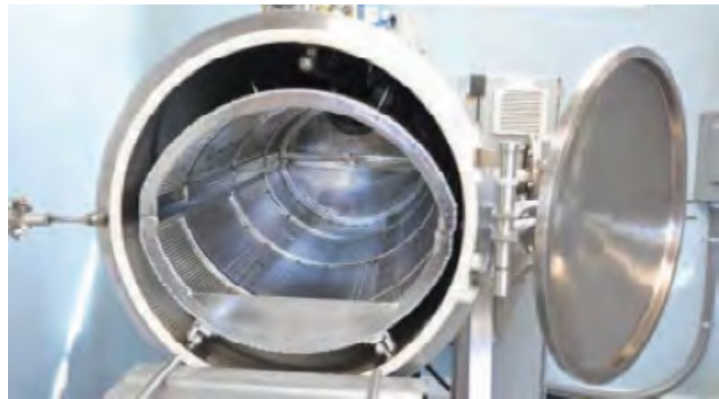
Figura 2. Sistema con el contenedor de canasta por dentro (Bio Response Solutions, s.f.)
