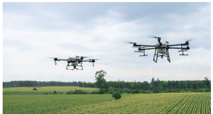
Figura 4. Atras T30 DJI, vehículo aéreo especializado en la fumigación de cultivos. (DJI News, 2023).
